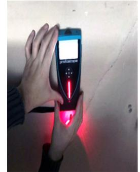
Localización de barras de refuerzo mediante detector de barras de refuerzo.
